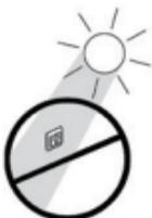
Platzieren Sie den Thermostat so, dass dieser nicht dem direkten Sonnenlicht ausgesetzt ist.
