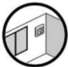
Platzieren Sie den Bodenfühler nicht in der Nähe von Türöffnungen oder an Stellen, an denen sich Sonnenlicht oder andere Wärmequellen im Fußbodenbelag befinden.
