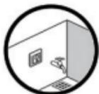
Der Thermostat darf nicht in direkten Nassbereichen (Zonen 0, 1 und 2) installiert werden. Befolgen Sie immer die lokalen Vorschriften bezüglich der IP-Schutzart. Dies bedeutet nicht, dass die Thermostate nicht in Badezimmern installiert werden können.
