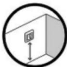
Installieren Sie den Thermostat in geeigneter Höhe an der Wand (typischerweise 80 – 170 cm)
