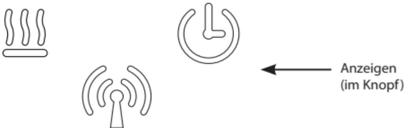
Alle Anzeigen werden nach einer bestimmten Zeit (Standardeinstellung 20 Sekunden) ausgeblendet, es sei denn, es liegt ein Fehler vor. Darüber hinaus leuchten die Anzeigen bei manueller Interaktion mit dem Thermostat, Änderung des Heizzustands, Programmereignis, App-Anschluss oder bei Auftreten von Fehlern/Warnungen.
